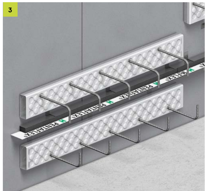
Neben das PENTAFLEX® Modul je zwei einreihige FERBOX® Rückbiegeanschlüsse an die Schalung annageln
