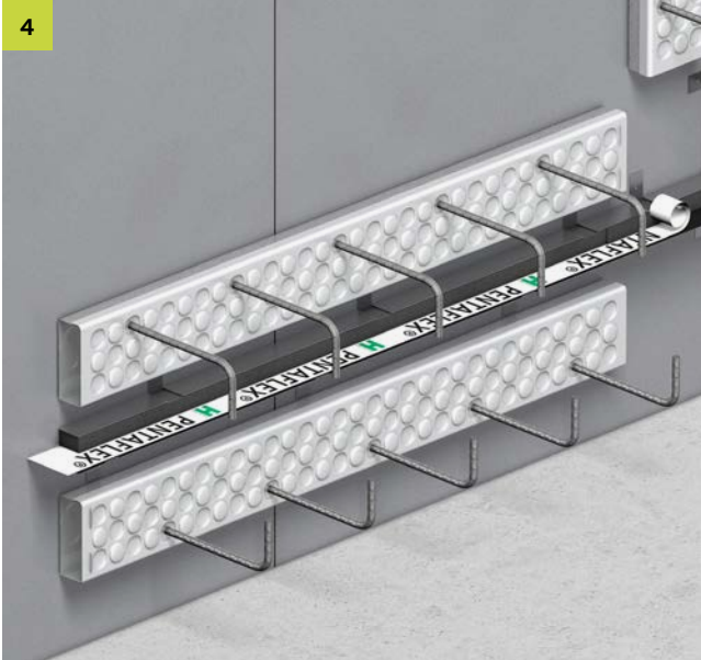
4 Vor dem Betonieren den oberen Teil der Schutzfolie vom PENTAFLEX® Fugenblech abziehen
